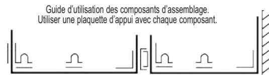
Placer une plaquette d'appui 87-122-F à l'endos de chaque autre composant d'assemblage du système.
